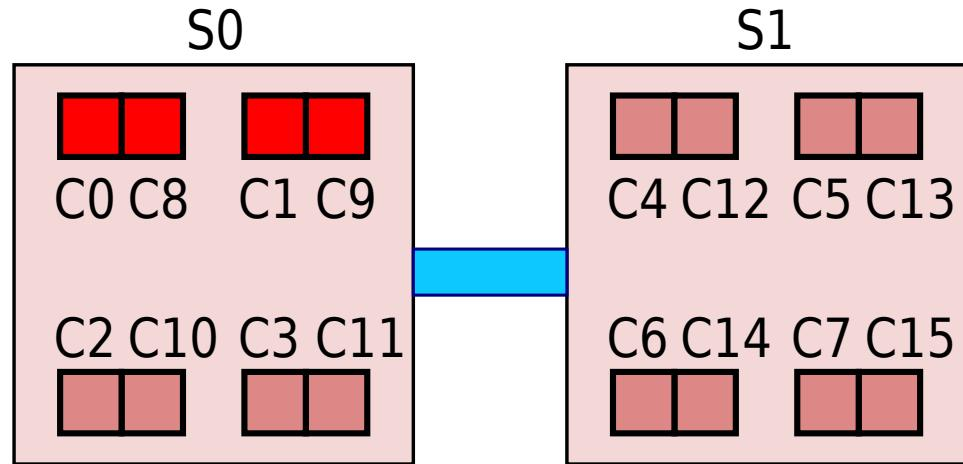
Exemple sur une architecture bi-sockets quadri-cœurs, avec l'hyperthreading activé.
